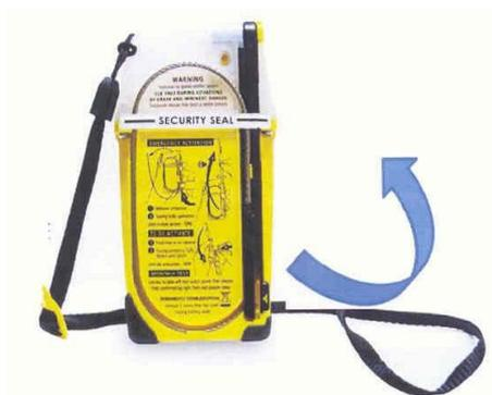
Déploiement de l'antenne en la prenant par le bas et en l'ouvrant vers le haut.
